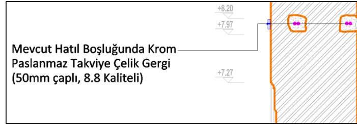
Şekil 16. Kot 3 ve kot 4 takviye detayı
